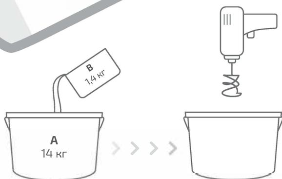
Герметик предназначен для герметизации сопряжений элементов конструкций с максимальной амплитудой знакопеременных циклических деформаций до 25 %, в том числе: деформационных швов, бетонных и железобетонных покрытий дорог, гидроизоляции бетонных покрытий при устройстве и ремонте автомобильных дорог (элементов мостов, тоннелей, железобетонных водоводов), контрольных швов в бетонных поверхностях.
